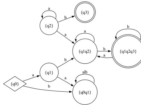
**Neuer Übergang  $b$**  aus  $\{q1q2q3\}$  nach  $\{q1q2q3\}$ , sowie neuer Übergang  $a$  nach  $\{q1q2\}$ .
