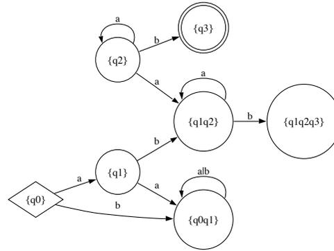
**Neuer Zustand  $\{q1q2q3\}$**  mit Übergang  $b$  aus  $\{q1q2\}$  und neuer Übergang  $a$  aus  $\{q1q2\}$  nach  $\{q1q2\}$ .
